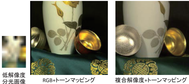
図3 金属光沢を含む画像の再現結果。高解像度 RGB 画像のみを用いたとき（中）は被写体の色が正しく再現できていないが、低解像度分光画像（左）を用いた複分解像度型処理を適用したもの（右）では、正しい色が表示され、かつ金箔などの光沢感が保たれています。
