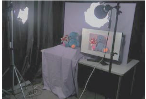
図4 背景の色の影響を調べるための主観評価実験に用いた実験系。被験者は実物を参考にしながら再現された映像を評価します。
