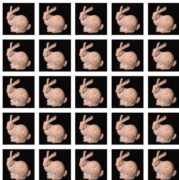
図1：自由視点提示に用いられる多眼カメラアレイによる撮影画像（ライトフィールド画像）。視点間による画像情報の違いは少なく、冗長性が高い。さらに、これらを撮影するには、視点数分のカメラをグリッド状に並べた高価なカメラアレイが必要である。
