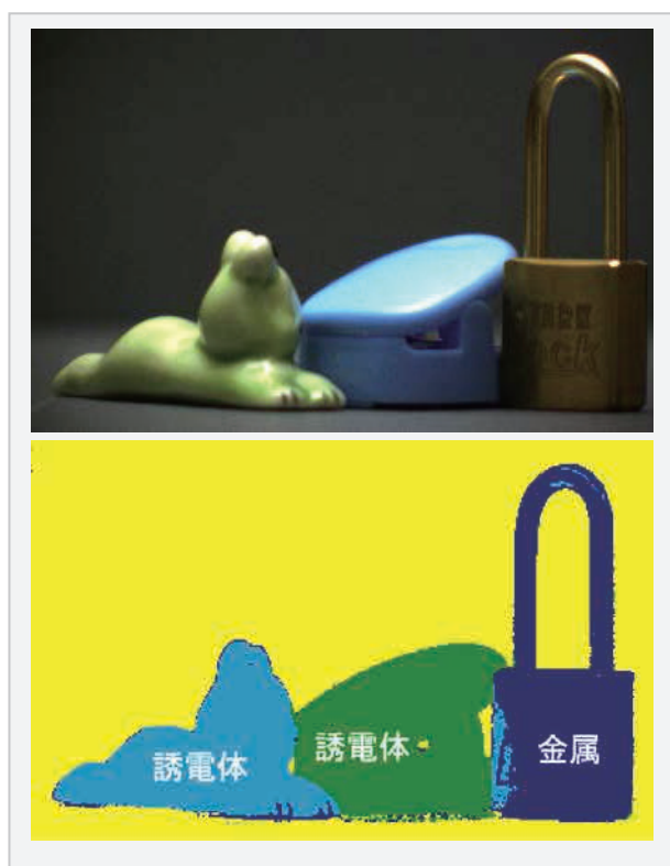
図 1. 実験例（上：入力シーン、下：材質識別結果）
