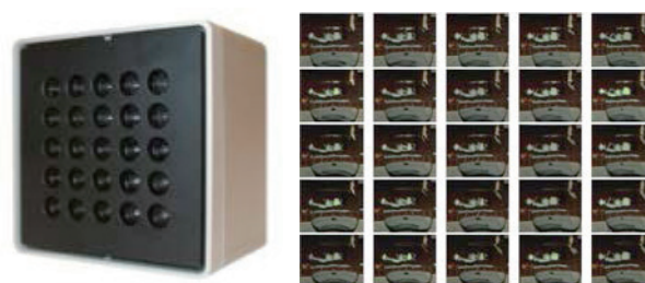
図2：ライトフィールドカメラとライトフィールド画像
