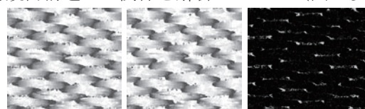
図3 反射光(左)・表面下散乱光(中)と差分(右)
