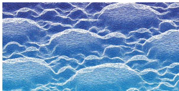
図 4-1: 革シボの凹凸情報から金型データを作成
