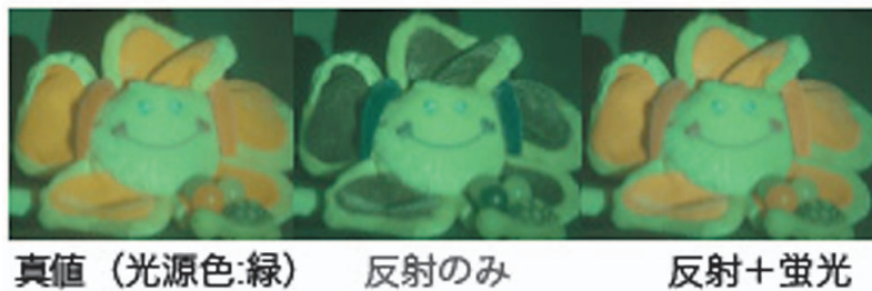
図4 実物体の蛍光反射特性のモデル化. 上段: 計測された蛍光成分と反射成分. 下段: 蛍光を考慮することにより正しい色再現が可能となる.
