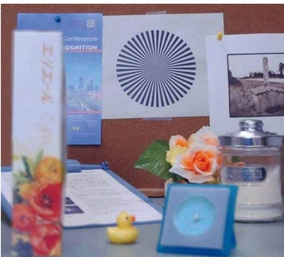
**多視点画像を撮影した後に、計算機内でピントの合わせ直し処理を行った例**
