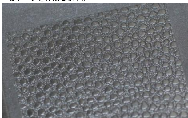
金型でシリコンを成形してサンプルを実体化します。
