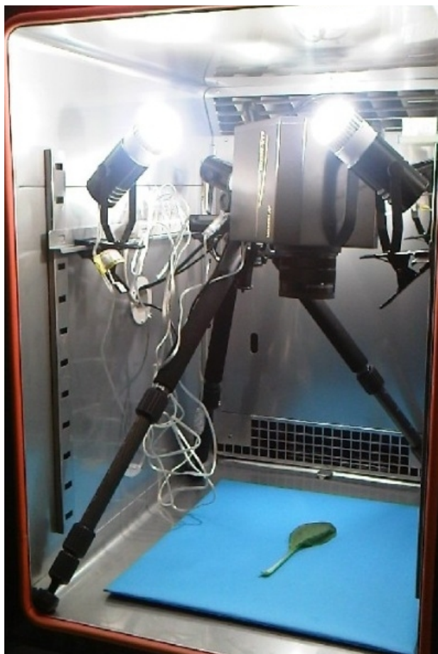
図 恒温恒湿槽内で系統的に鮮度劣化させた小松菜の測色値画像を2次元色彩計で取得している様子
