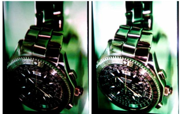
図2 電子ペーパーと複数プロジェクタを組み合わせた高精細ハイダイナミックレンジディスプレイの表示結果を、カメラで撮影したもの。カメラの露出を下げて撮影すると、つやや背景部分などの高輝度部の階調が現れており、一方、露出を上げて撮影すると、文字盤などの暗部も再現されていることが分かります。
